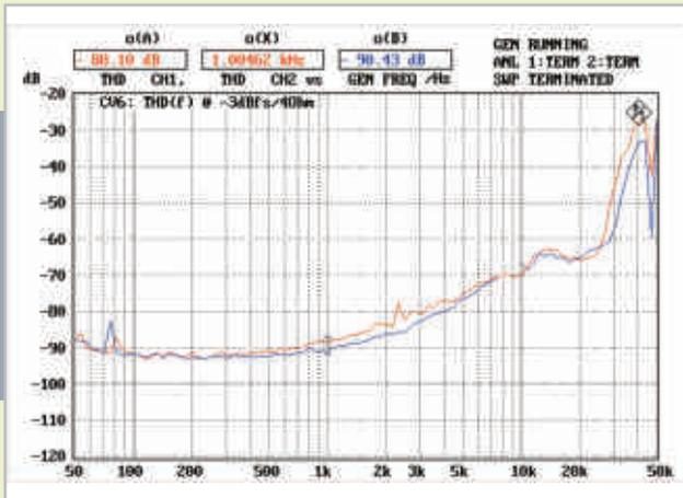
Abb. 9: Klirrfaktor (THD) über der Frequenz 3 dB unter Vollaussteuerung und 2 x 4 Ohm Last (CH1, CH2)
