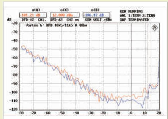
Abb. 12: Differenztonverzerrungen (10,5 kHz und 11,5 kHz) und 2 x 4 Ohm Last (CH1, CH2)
