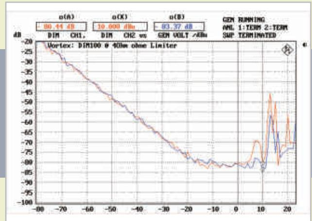
Abb. 10: Intermodulationsverzerrungen DIM100 (3,15 kHz und 15 kHz) und 2 x 4 Ohm Last (CH1, CH2)
