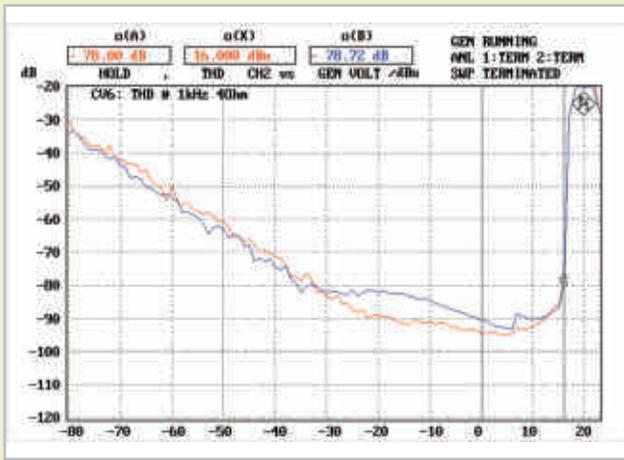
Abb. 7: Klirrfaktor (THD) bei 1 kHz und 2 x 4 Ohm Last (CH1, CH2)
