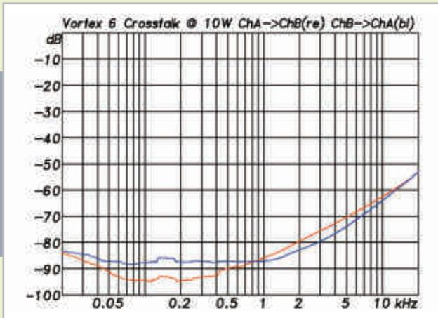
Abb. 3: Übersprechdämpfung (CH1→CH2, CH2→CH1)
