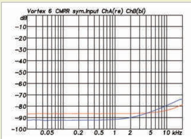
Abb. 5: Gleichtaktunterdrückung (CH1, CH2)
