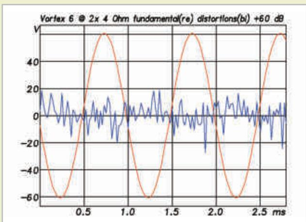
Abb. 16: 1 kHz Grundwelle und Verzerrungsanteile (50 dB vergrößert)
