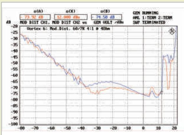
Abb. 11: Modulationsverzerrungen nach SMPTE (60 Hz und 7 kHz) und 2 x 4 Ohm Last (CH1, CH2)
