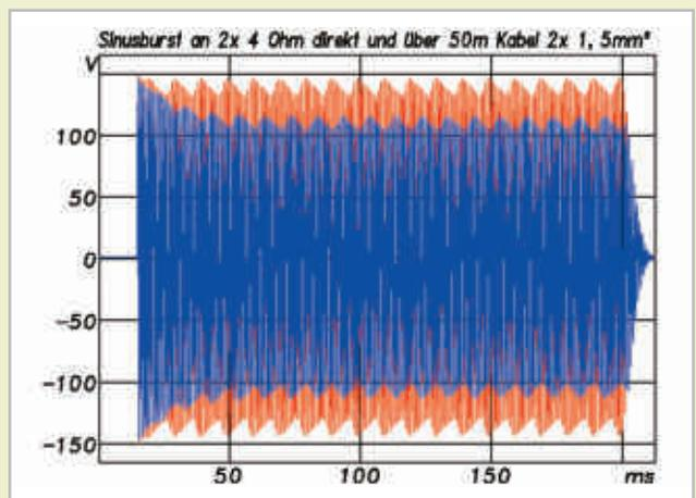
Abb. 17: Verhalten der Vortex 6 an einer stabilen Stromversorgung (re) und über 50 m Kabel (bi)
