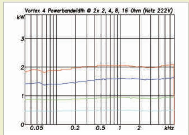
**Abb. 13: Zweikanalige Dauerleistung bei 1 % THD an 2 (rt), 4 (bl), 8 (gr) und 16 (hbl) Ohm Last (links Vortex 6; rechts Vortex 4)**
