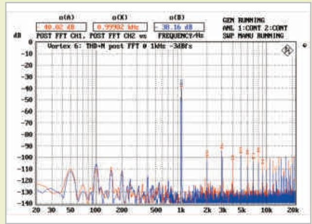
Abb. 8: Klirrspektrum bei 1 kHz und 2 x 4 Ohm Last (CH1, CH2) 3 dB unter Vollaussteuerung (Grundwelle bei 1 kHz um 40 dB gedämpft)
