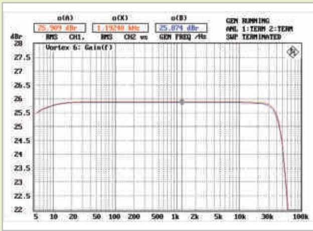
Abb. 1: Verstärkung über der Frequenz (CH1, CH2)
